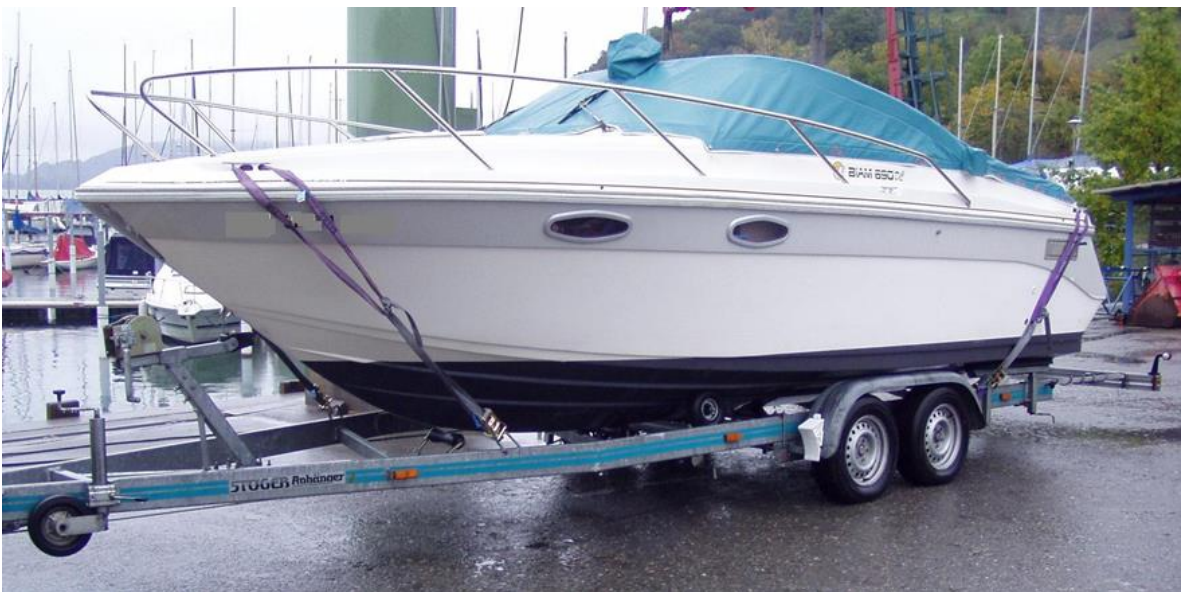
Direktzurrung: Hier wird im geraden Zug die Bewegung des Bootes verhindert.
