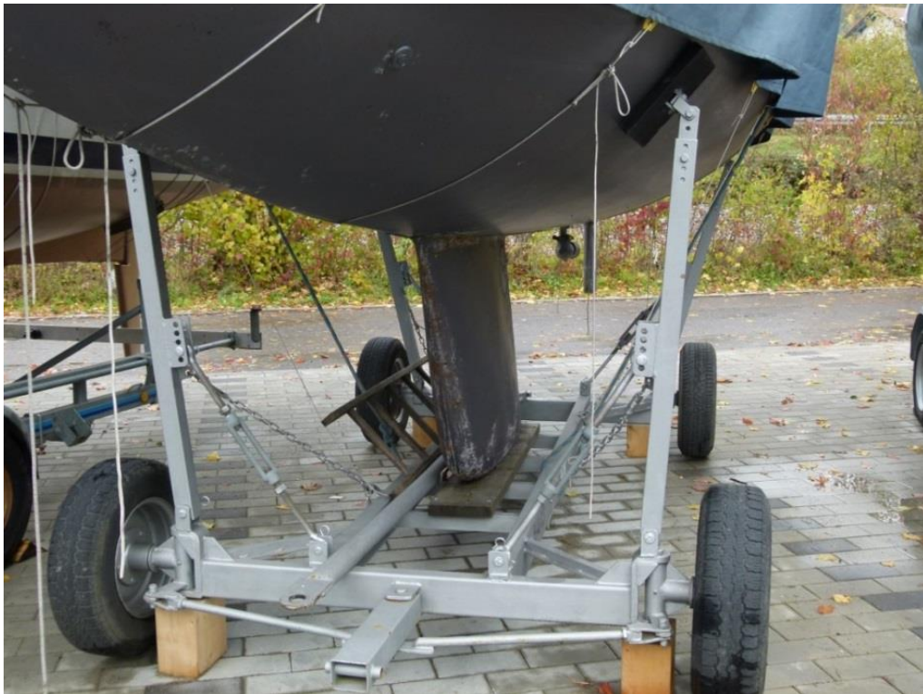
Anhänger ohne Bremsanlage und Kielanschlag
