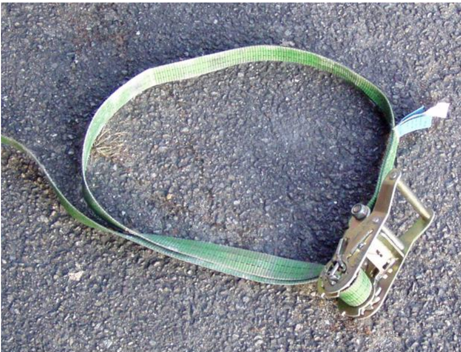
Kopfschlinge aus einem einteiligen Zurrurt
