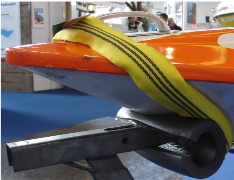
Kopfschlinge mittels Schlaufengurt
