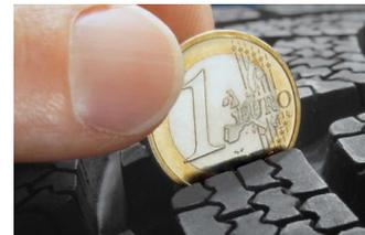
Eine weitere Möglichkeit bieten die sogenannten TWIs am Reifen selbst (TreadWearIndicator). Jeder Reifen besitzt solche Marken in den Hauptprofilrillen, die sich genau bei der Ablaufgrenze von 1,6 mm befinden. Sind diese Marker mit dem Profil auf einer Ebene, dann ist die Abfahrsgrenze von 1,6 mm erreicht.
